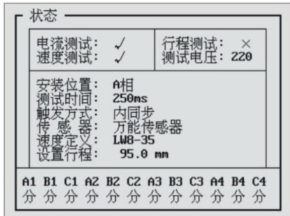
答：选择【测试】—【合闸测试】，仪器液晶显示屏的最下方有 12 断口的实时状态显示。屏幕显示如下图：
